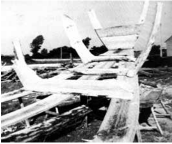
Fig. 11 - Construção de um saveiro, tal como a dos barcos rabelos, com o assentamento do fundo, e posterior aplicação das cavernas e cobertura com o costado
