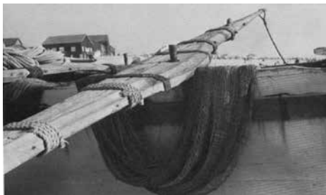
Fig. 13 – Remo de um saveiro e sua fixação ao tolete, exactamente igual aos remos e sua fixação que se pode observar nos antigos Curroughs da Irlanda
